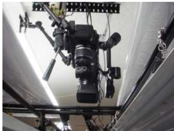
左：カメラを天井部に備え付けるための枠のイメージ図 右：実際に天井部に備え付けられたデジタルカメラとハイビジョンカメラ
