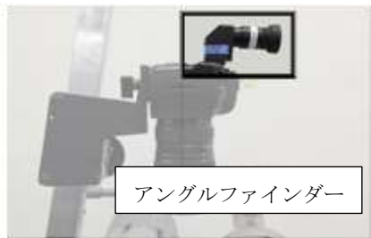
カメラを真下に向けることでファインダーが使いやすくなるため、アングルファインダー（接眼アタッチメント）を用いる
