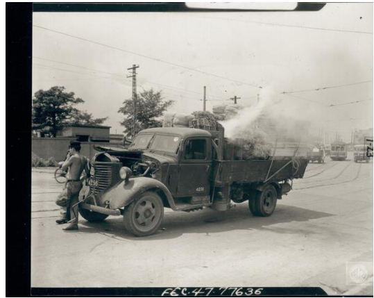
東京交通プロジェクト・木炭燃料ガス自動車・ガス圧力不足でしばしばストップ・交通渋滞の原因
