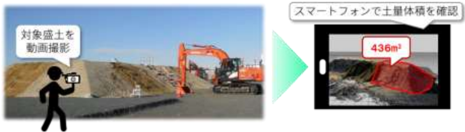
図5-6 スマートフォンによる土量計測 出典：日立ソリューションズ「GeoMation スマートフォン活用3D計測ソリューション」
