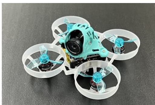
図 6-7 FPV マイクロドローン（100 g 未
